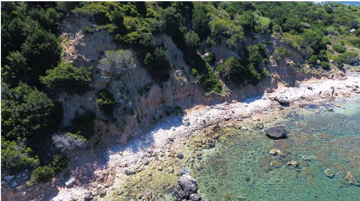
Figura 21: Settore del versante interessato da processi di frana. a) substrato roccioso a litologie granitiche; b) deposito di versante interessato da processi gravitativi; c) processi di erosione areale e processi di erosione concentrata (d).
