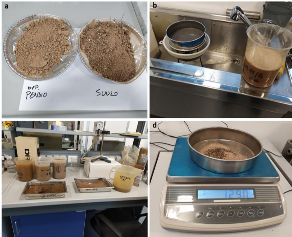
Figura 13: Fasi di esecuzione analisi granulometriche. a) Campioni essiccati. b) Fase di lavaggio da passante a 63 micron. c) Campioni lavati. d) Pesata del trattenuto per ogni singola granulometria.
