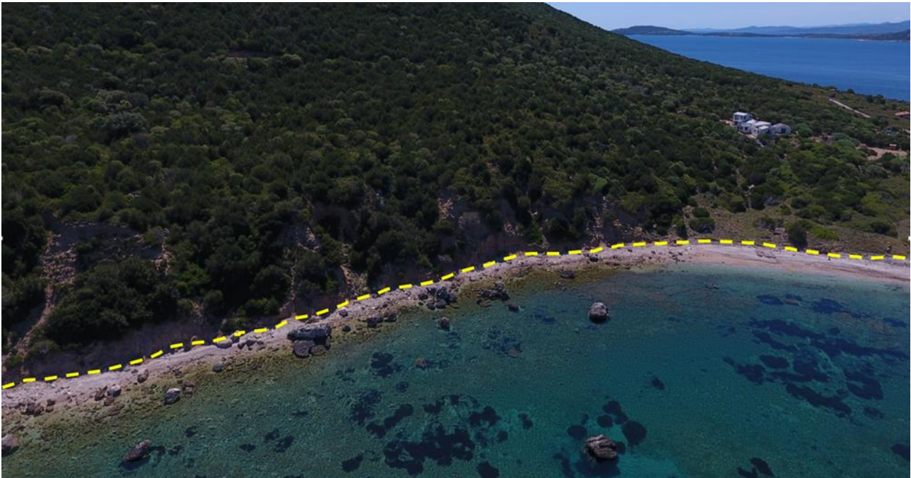
Figura 25: In evidenza il limite del wave run-up.
