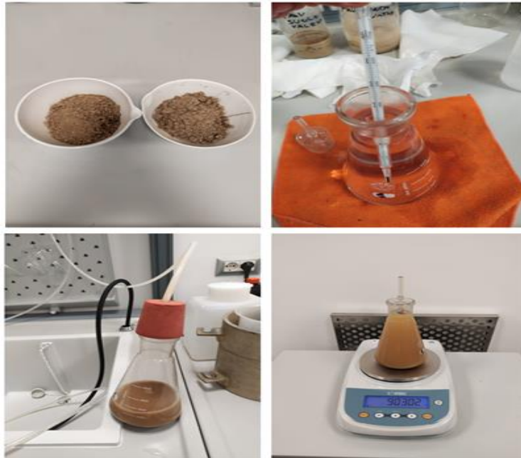
Figura 16: Pesata del picnometro.
